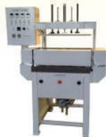
■プリスター三方折曲機は、スライドプリスター包装用の容器の三方の縁を折り曲げる為の機械です。三方の縁を折り曲げた容器に商品を入れ、台紙をスライド差し込みして台紙が抜けないようにテープ止めなどをして完成です。
