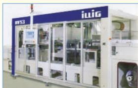
■全自動型連続真空圧空成形機はシートの加熱ゾーンと成形ゾーンが分かれているため、生産性の高い設備です。成形の次でトリミングされ、その次でスタッピングされます。スタッピングされた物がコンベアーで排出されます。トリミングで残ったスケルトンはドラム上に巻き取られます。真空成形、圧空成形、真空圧空成形を切り替えられます。圧空を使った成形はエッチ形状がシャープになります。
